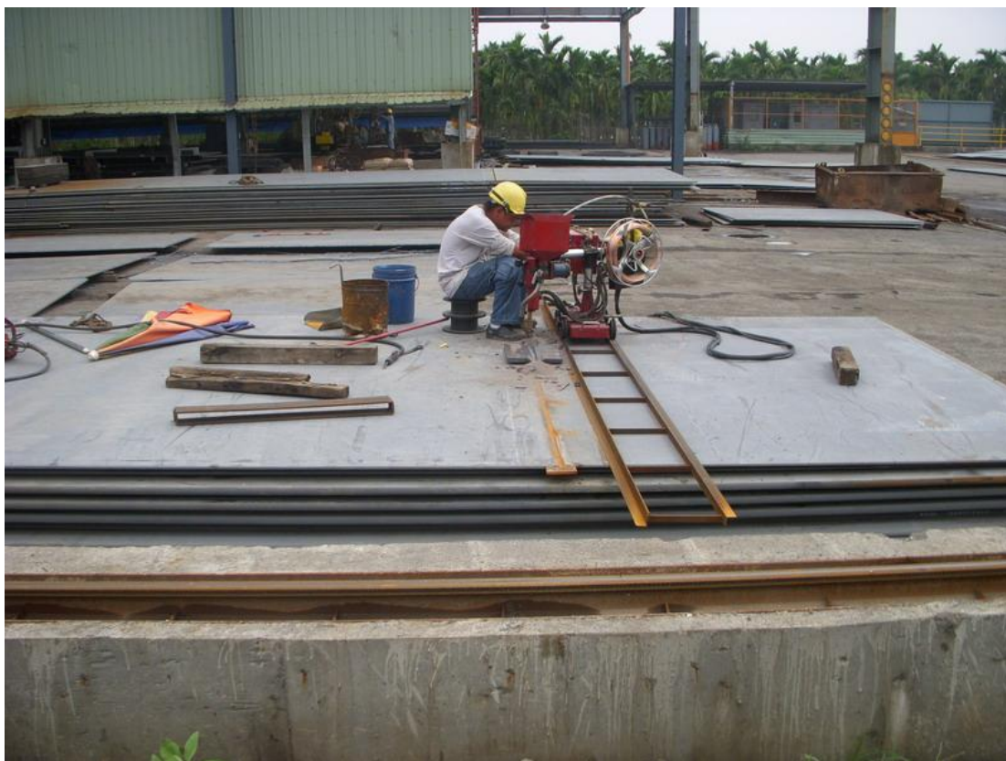
圖片 3-7(露天電銲影響銲接品質)
