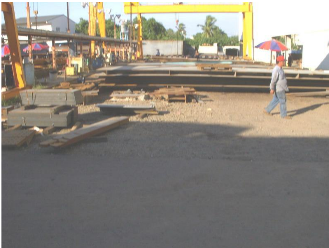
圖片 3-6(露天組立電銲影響銲接品質)
