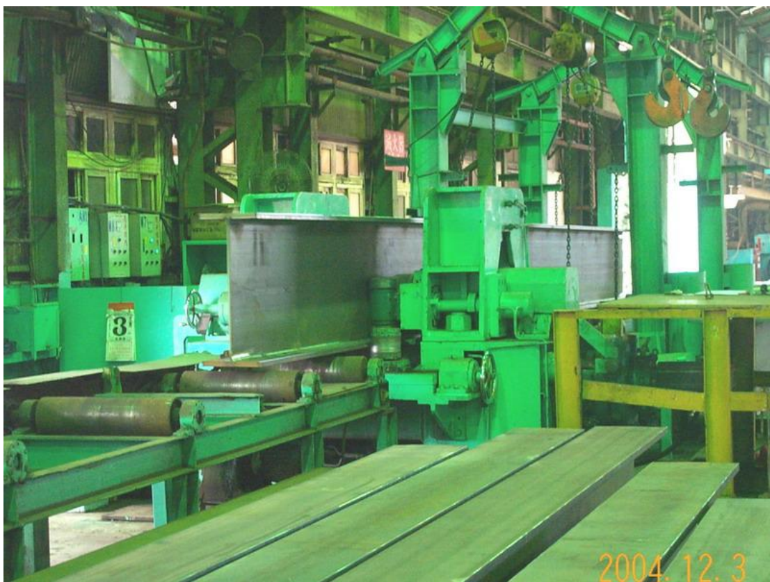
圖片 3-5(BH 機械整形機無法適用於鋼箱型梁)
