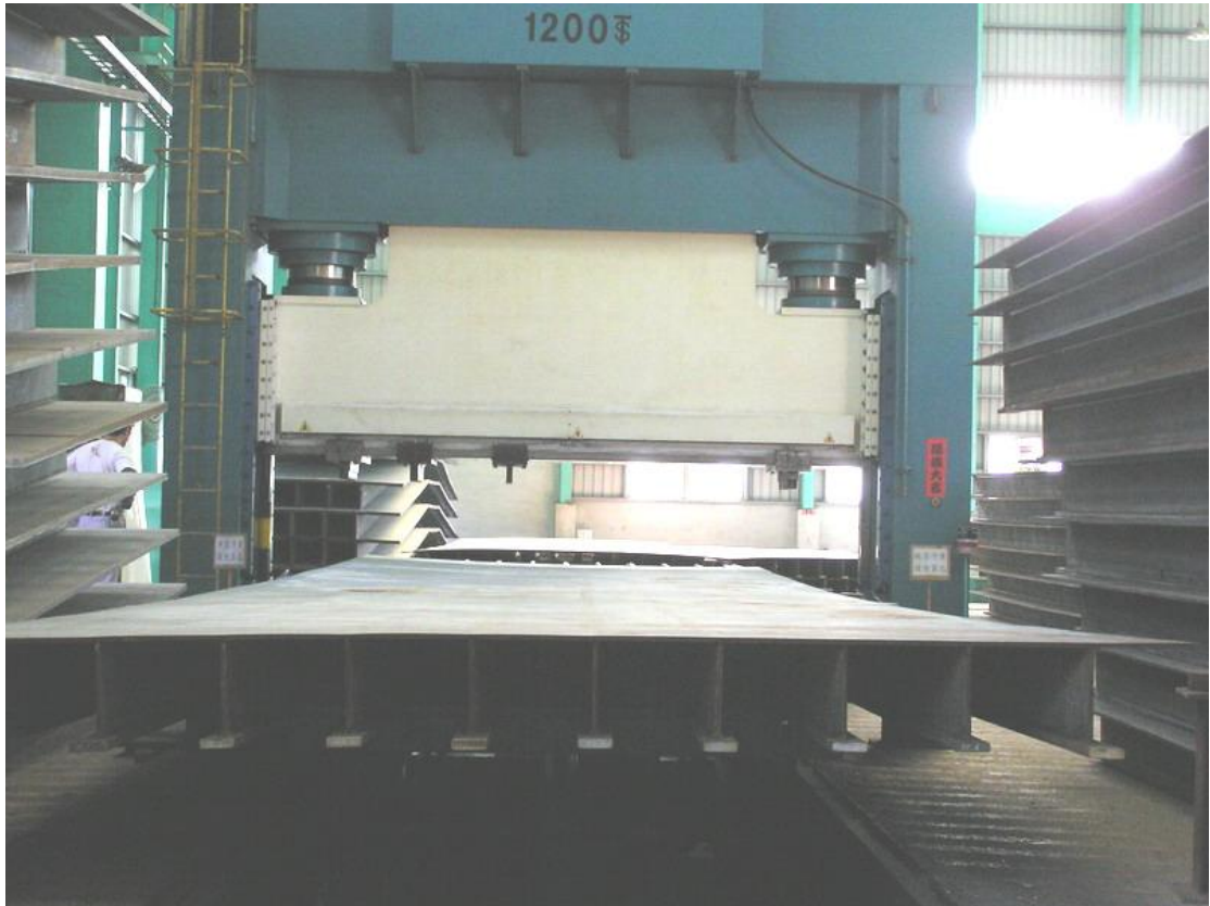
圖片 3-16(小組銲接變形機械壓床整形)
