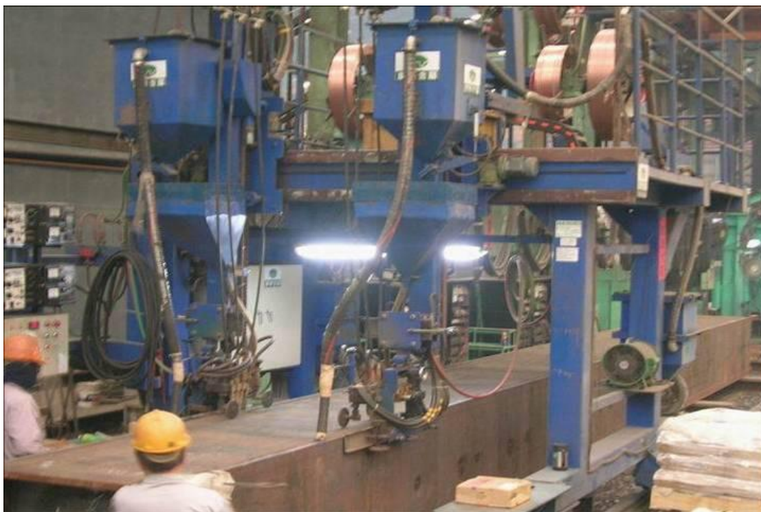
圖片 3-4(門型自動潛弧銲機無法適用於鋼箱型梁)
