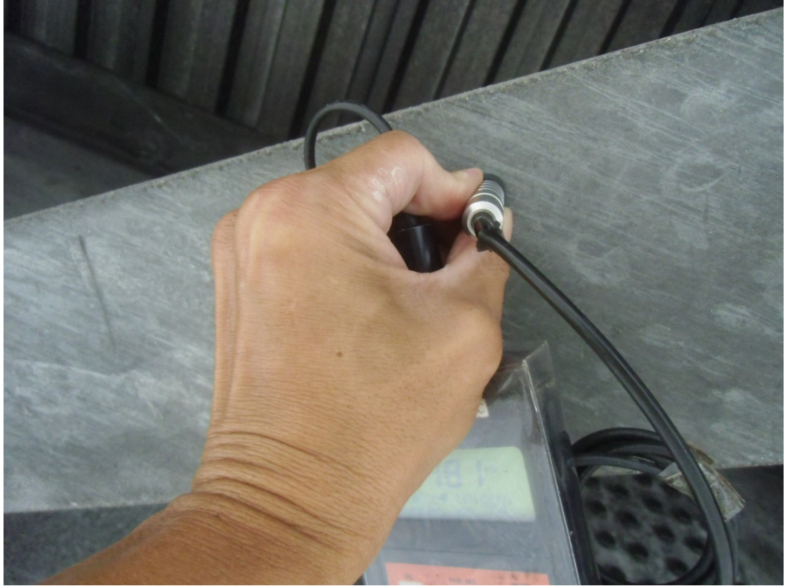
圖十八 熱浸鍍鋅板梁膜厚量測(181 \mu m)
