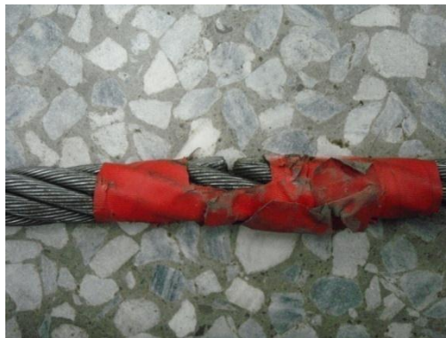
圖 6 鋼纜之人工缺陷(缺陷深度 6.55mm)
