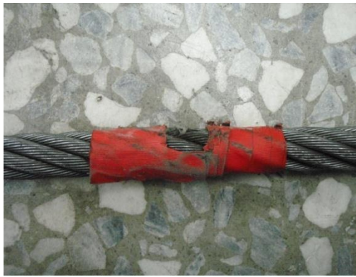
圖 5 鋼纜之人工缺陷(缺陷深度 2.5mm)
