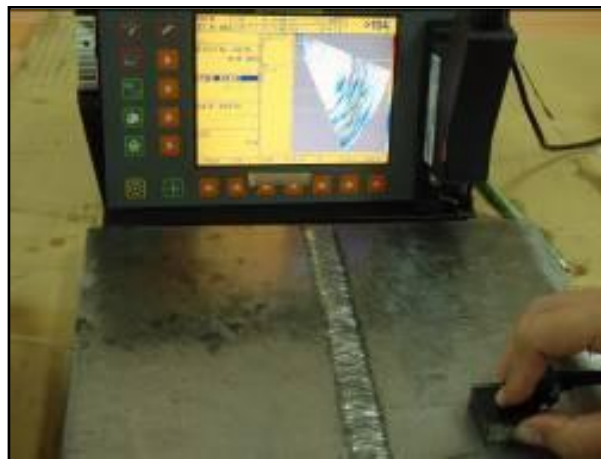
圖 2 鉸接試件檢測(相位陣列式 UT)
