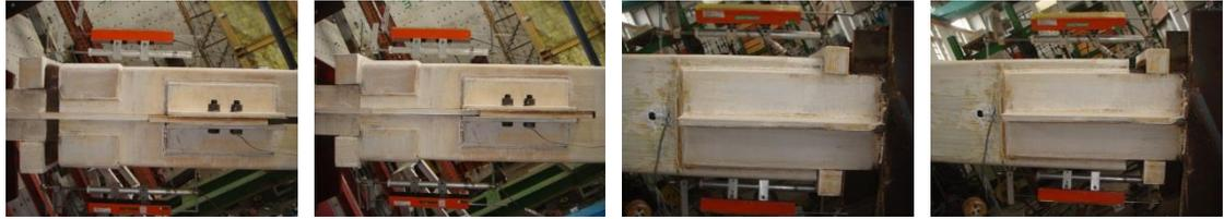
受軸拉時上側外端板分離      受軸壓時上側外端板緊貼      受軸拉時下側外端板緊貼      受軸壓時下側外端板分離
