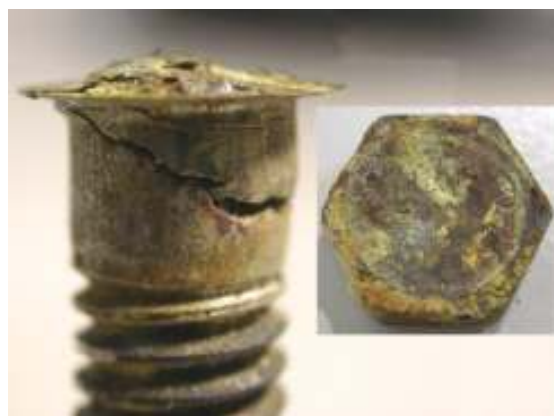
圖四 螺栓延遲破壞由頸部斷裂
