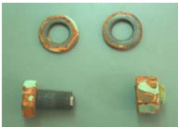
圖三 螺栓延遲破壞由牙部斷裂
