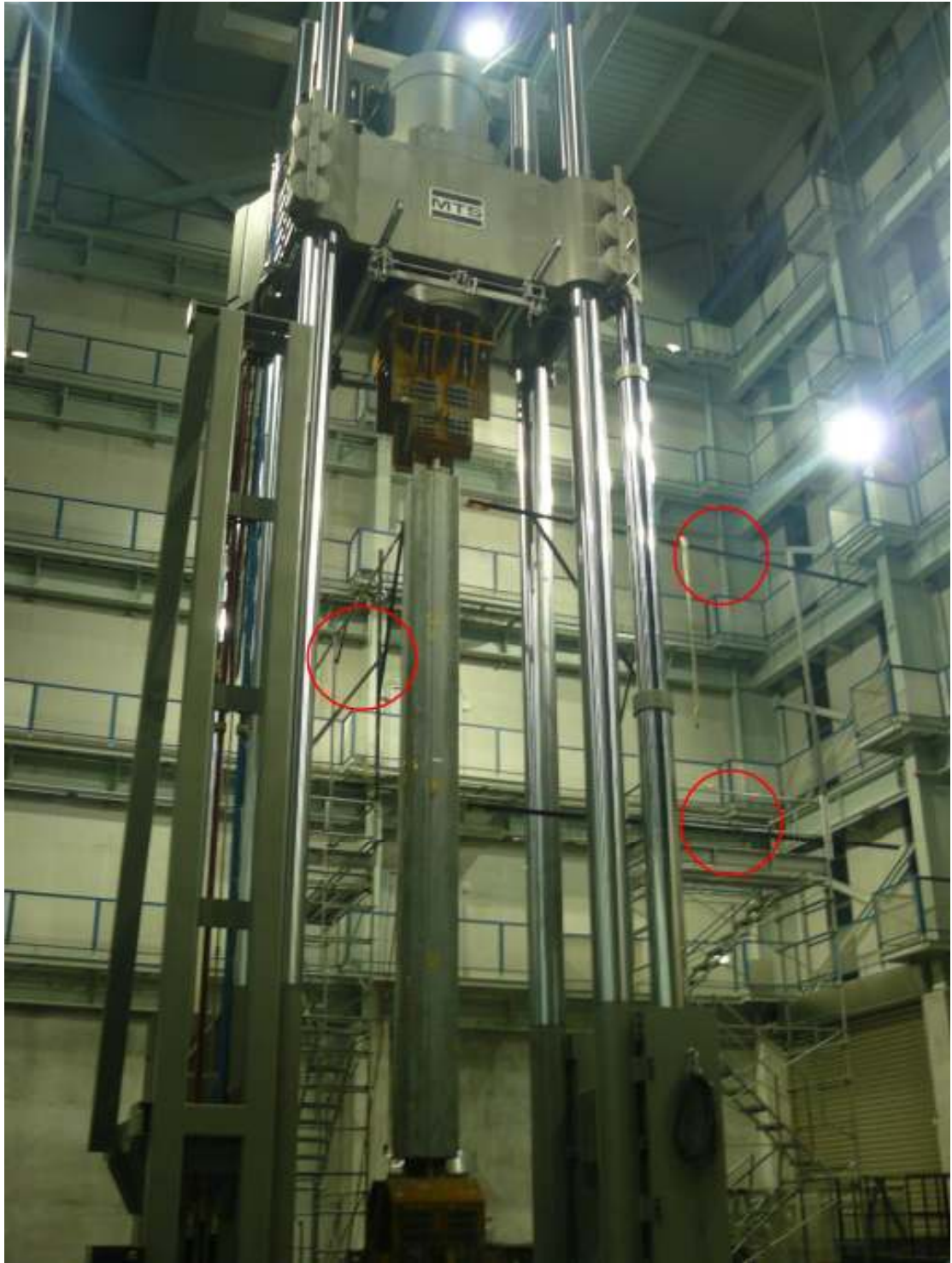
圖 3-5 載重試驗前之試體及試驗裝置
