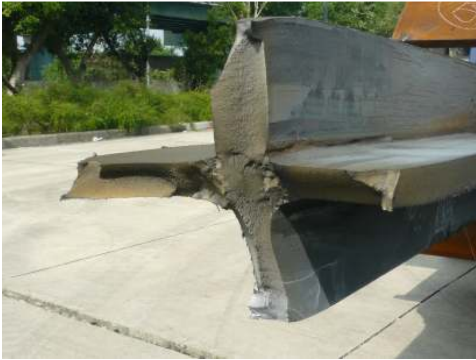
圖 3-11 試驗後 BRB 試體主受力元件斷裂處剖面
