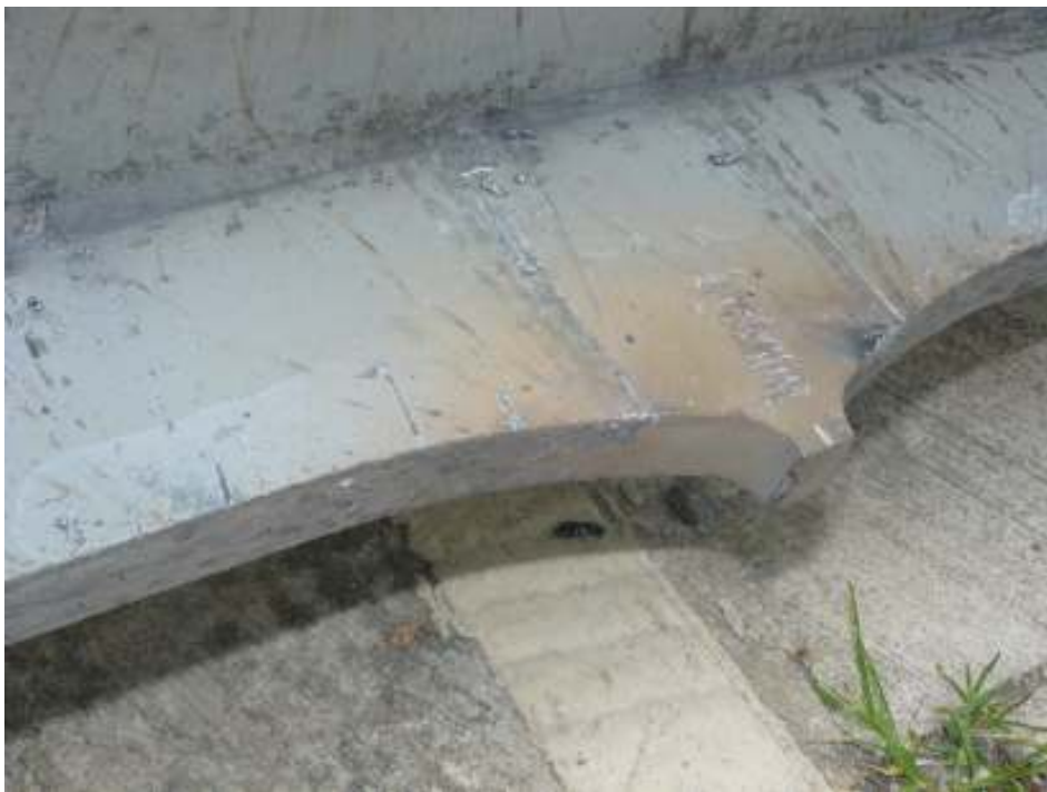
圖 3-12 試驗後 BRB 試體主受力元件卡樺之檢視情況
