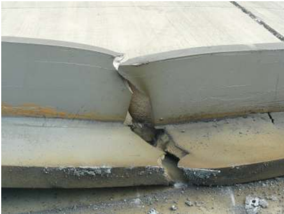
圖 3-10 試驗後 BRB 試體主受力元件之斷裂面情況
