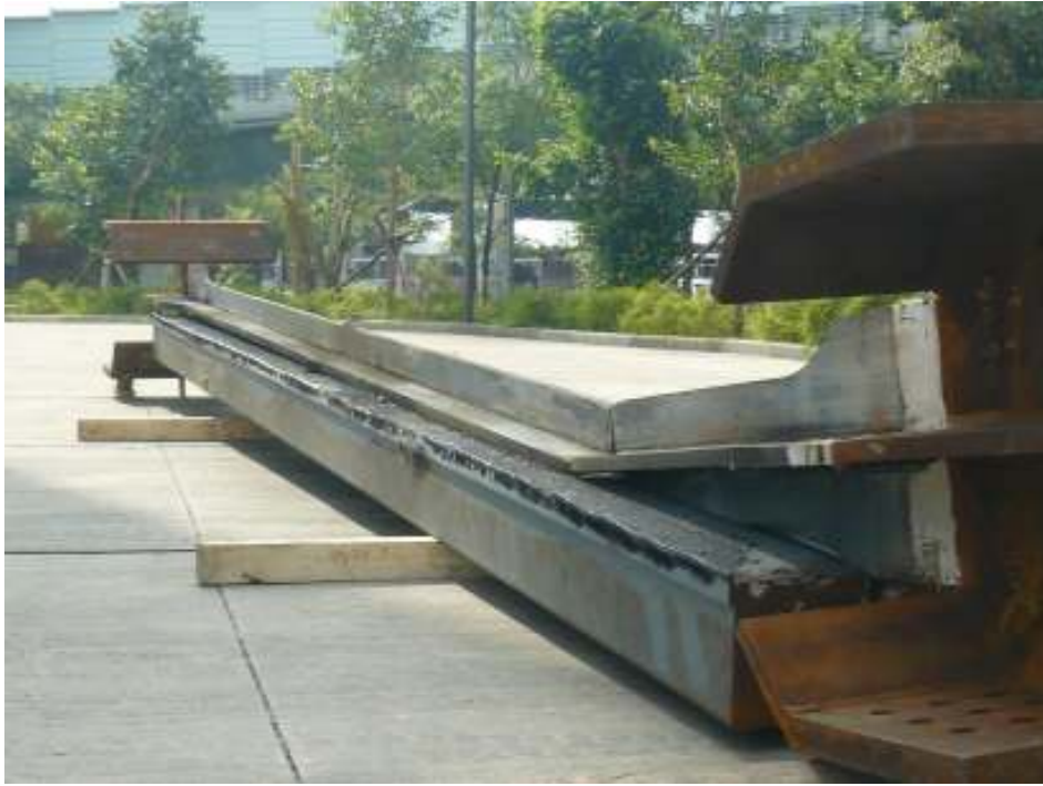
圖 3-9 試驗後 BRB 試體剖開檢視之情況
