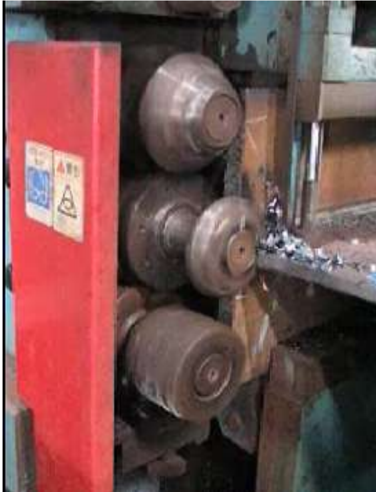
圖 8 自動銑刀設備製作扇形孔
