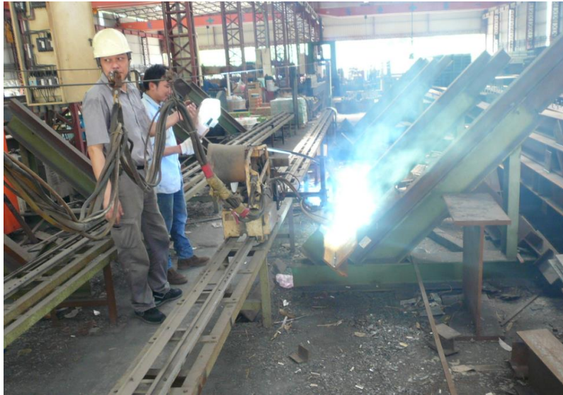
圖 3.2 半自動銲接機進行 BH 型鋼組立 (GMAW)
