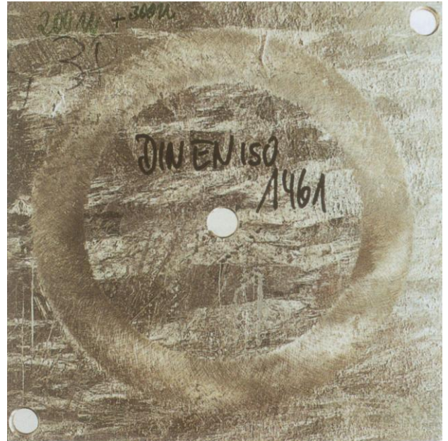
圖五 熱浸鍍鋅試驗樣品
