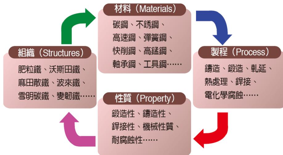
圖 1 鋼鐵材料中「材料」、「組織」、「性質」、「製程」的因果關係
