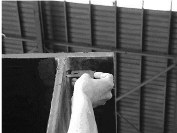
圖 9-7 角銲之腳長量測 【1】
