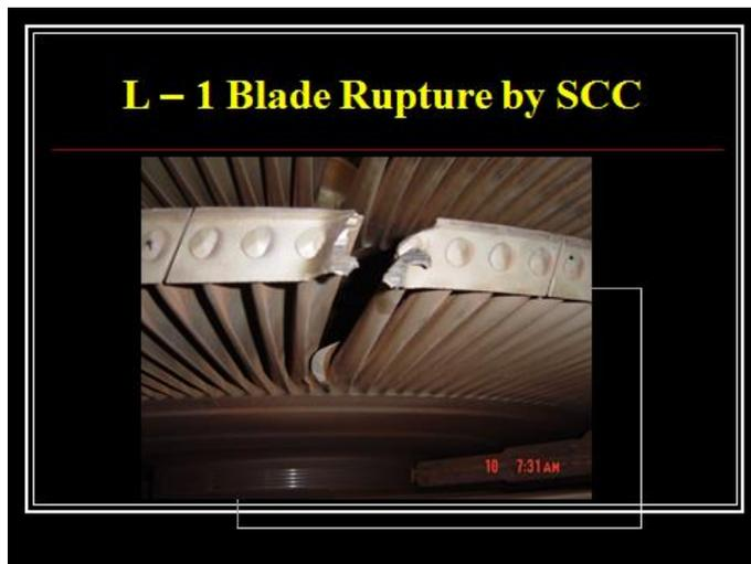
照片 3：汽機葉片因海水洩漏腐蝕斷裂
