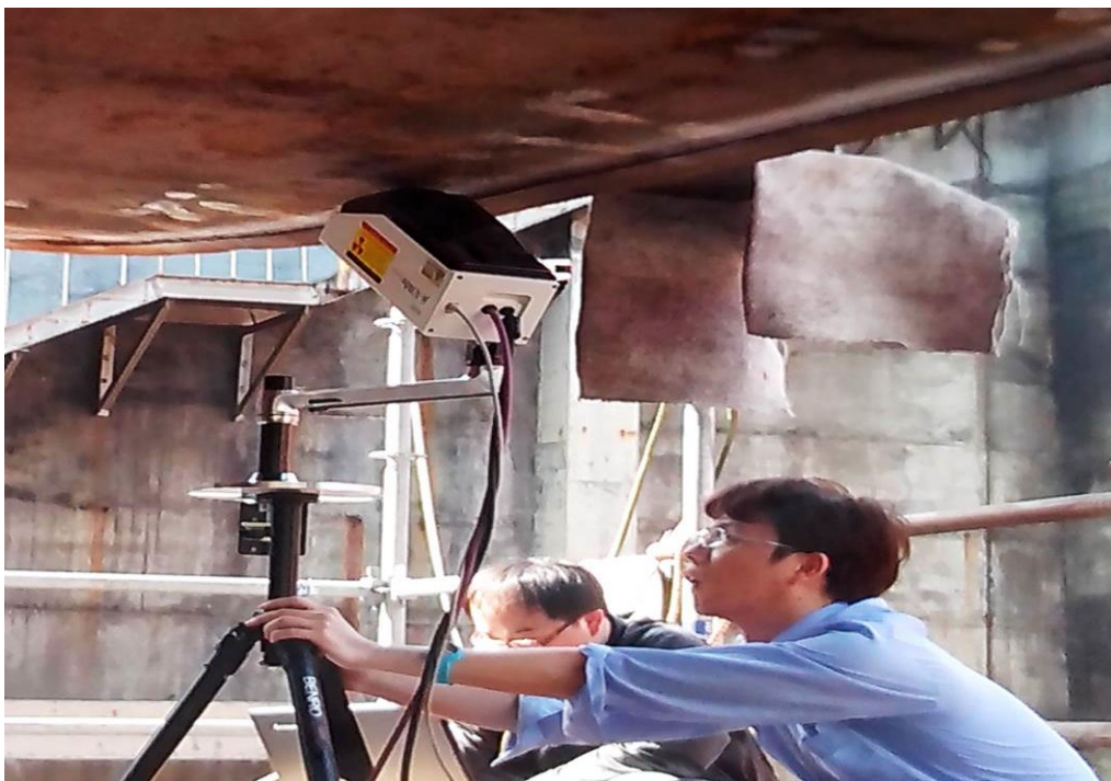
圖二、以 X 光進行現場之殘留應力量測
