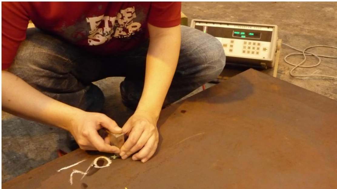
圖六、以磁彈方式量測鋼板不同位置之應力分佈
