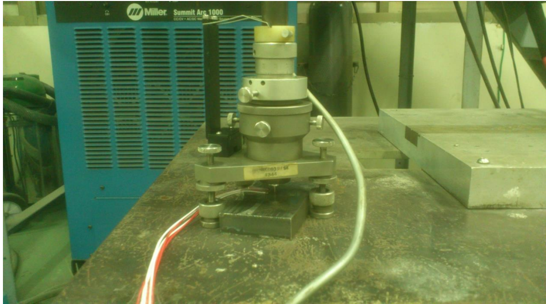
圖五、以盲孔法量測試片之應力縱深分佈
