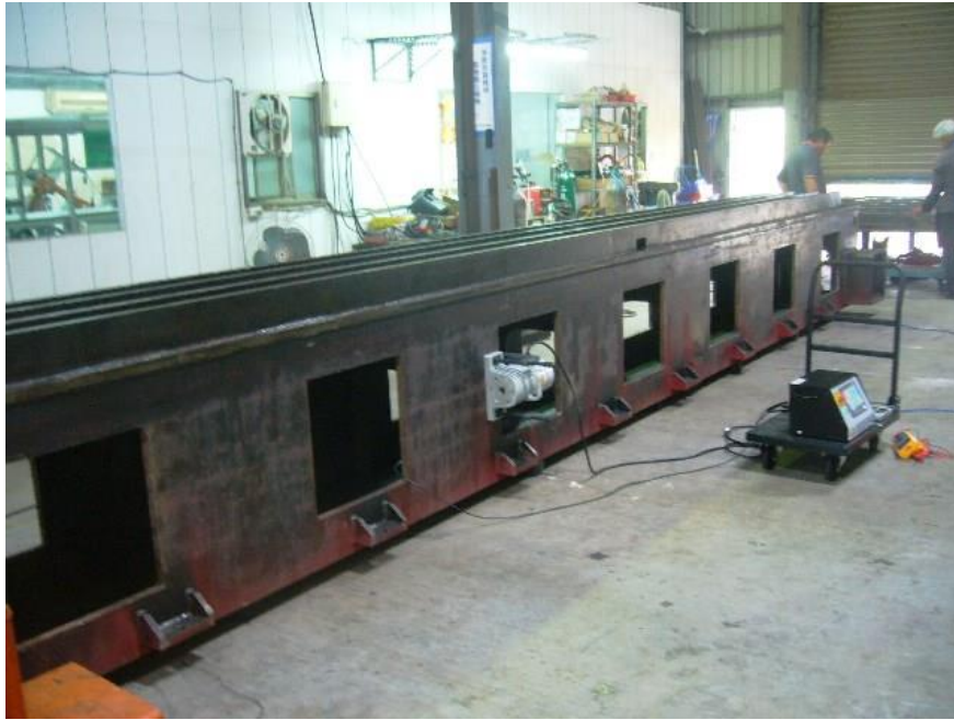
圖一、以振動方式消除鋼結構件之殘留應力
