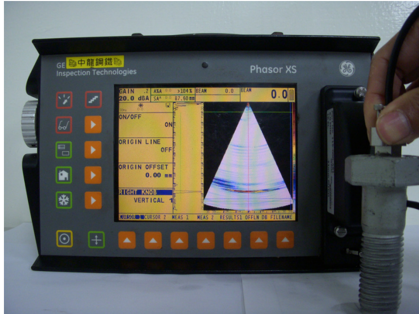
圖 6 相位陣列式超音波檢測螺栓
