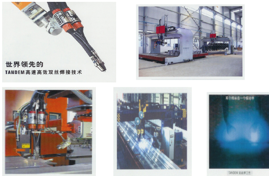
圖 3 Tandem & 2 Wires MAG (是傳統單槍 MAG 鐸接速率之 2.67 倍 20mmt 鋼板) 資料來源: Cloos Co., Message
