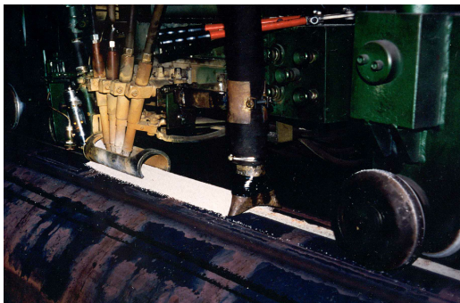
圖 2 高熔填率鐸材可應用於 4 極 SAW 鐸接製程(管件鐸接)
