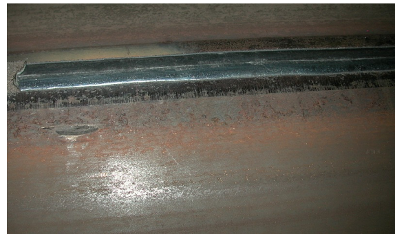
圖 2 高熔填率鐸材可應用於 4 極 SAW 鐸接製程(管件鐸接)
