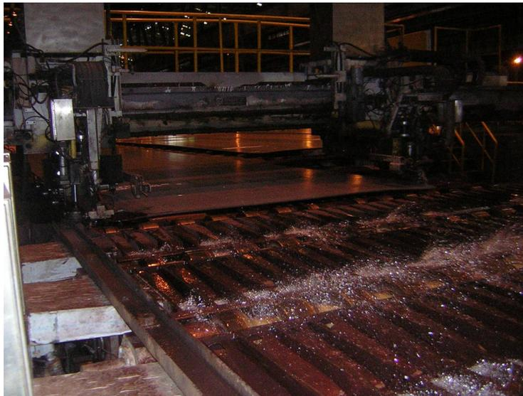
圖 1 鋼板自動超音波檢測設備
