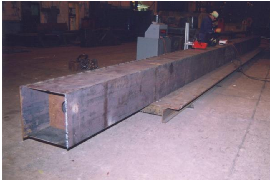
圖三 震動技術消除鋼結構件內部殘留應力
