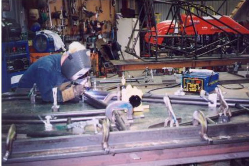
圖五 Meta-Lax 技術運用於鋼結構件銲接
