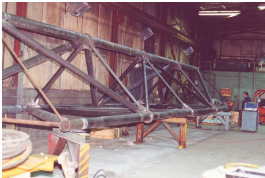
圖四 Meta-Lax 技術消除大型鋼結構件殘留應力
