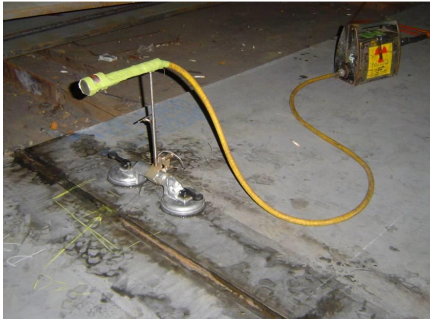
圖 1 放射線檢測銲道品質( \gamma 射線)
