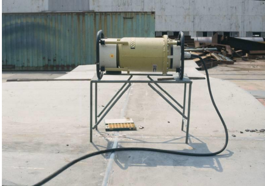
圖 2 放射線檢測鐸道品質(X 射線)
