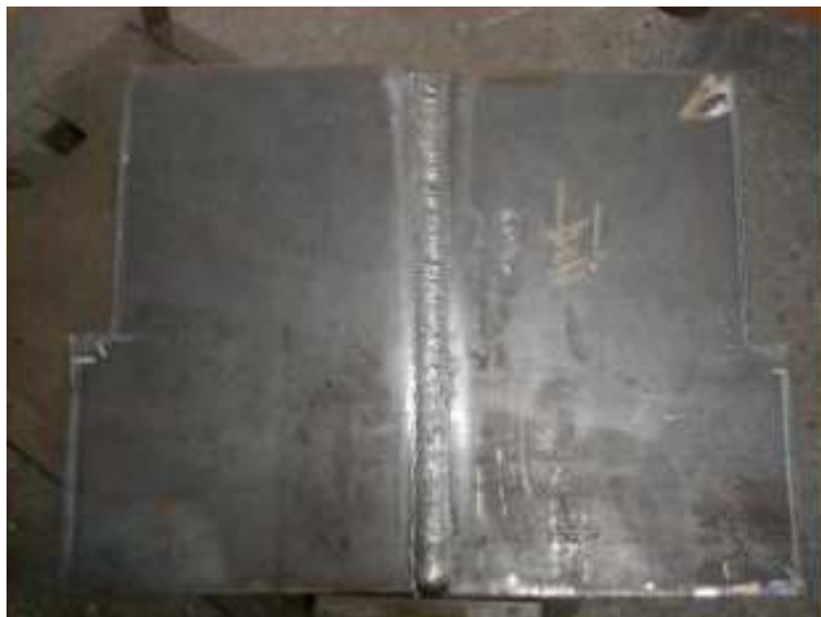
鐸道形狀(除渣後)
