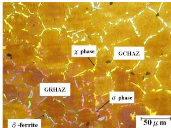
圖 9 430 不銹鋼結構材料於銲接過程中  $\sigma$  相的顯微組織
