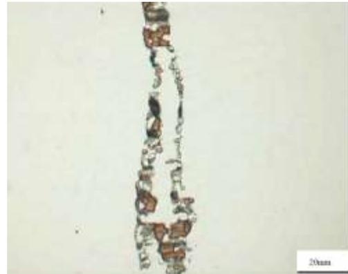
(a) 309 不銹鋼結構材之  $\sigma$  相鑄造組織 (b) 316 不銹鋼結構材之  $\sigma$  相軋延組織<sup>[30]</sup>
