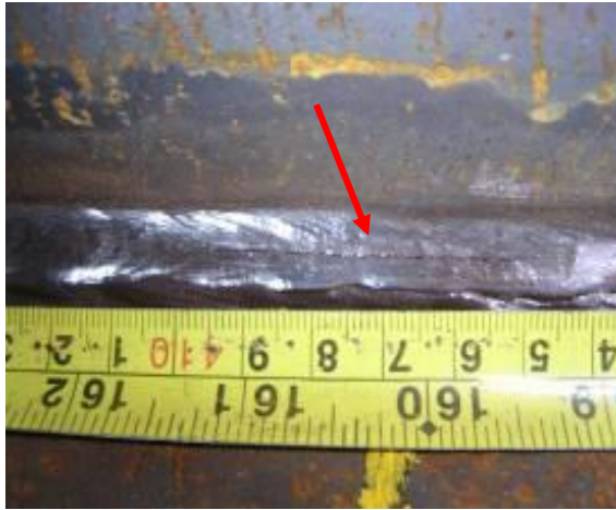
圖 2 裂縫(銲喉縱裂)
