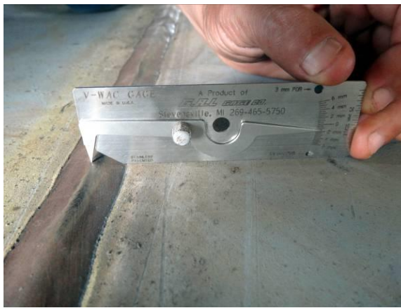
圖 20 銲冠高度量測
