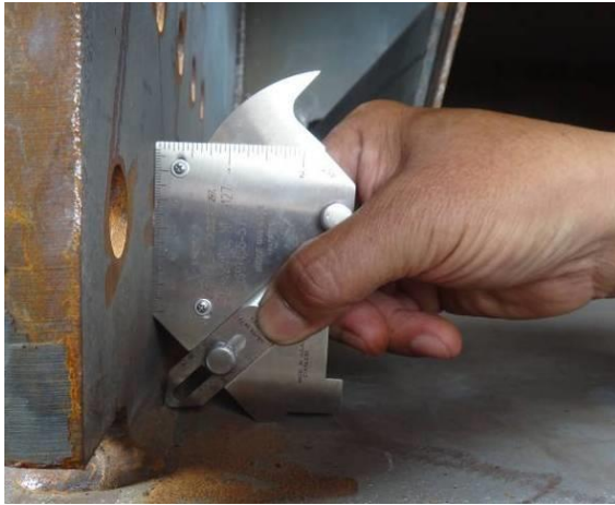
圖 18 銲接尺寸量測(喉深)
