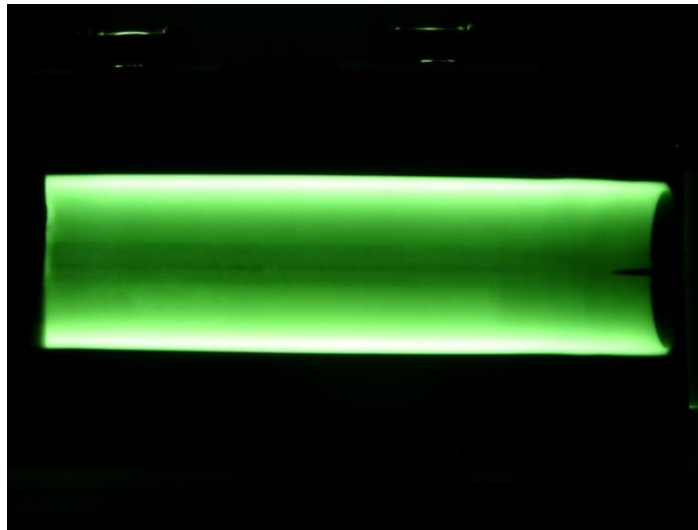
圖 4 有縫管 (RT 檢測)
