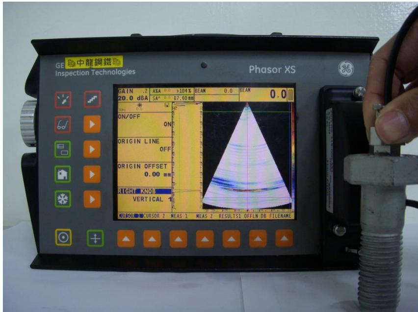
圖 1 相位陣列式超音波檢測螺栓
