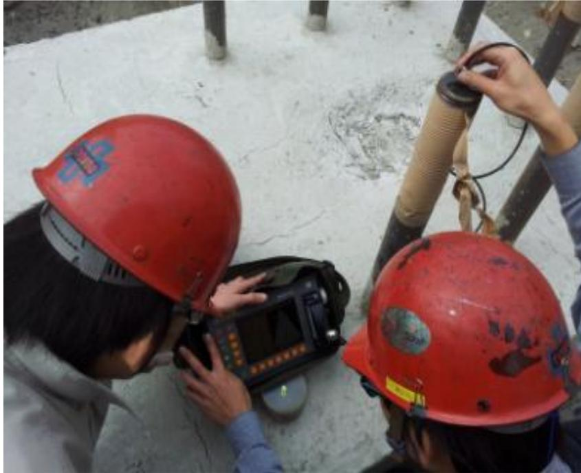
圖 7 相位陣列式超音波檢測基礎螺栓
