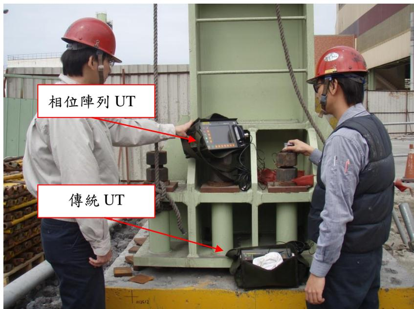
圖 6 相位陣列式超音波與傳統超音波檢測基礎螺栓(含螺帽)
