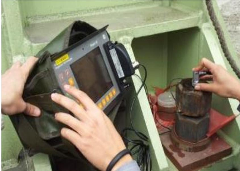
圖 5 相位陣列式超音波檢測基礎螺栓(含螺帽)
