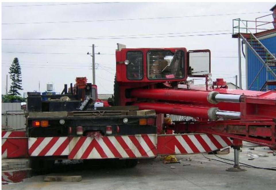
圖1 移動式起重機旋轉體翻覆事件(固定螺栓斷裂)
